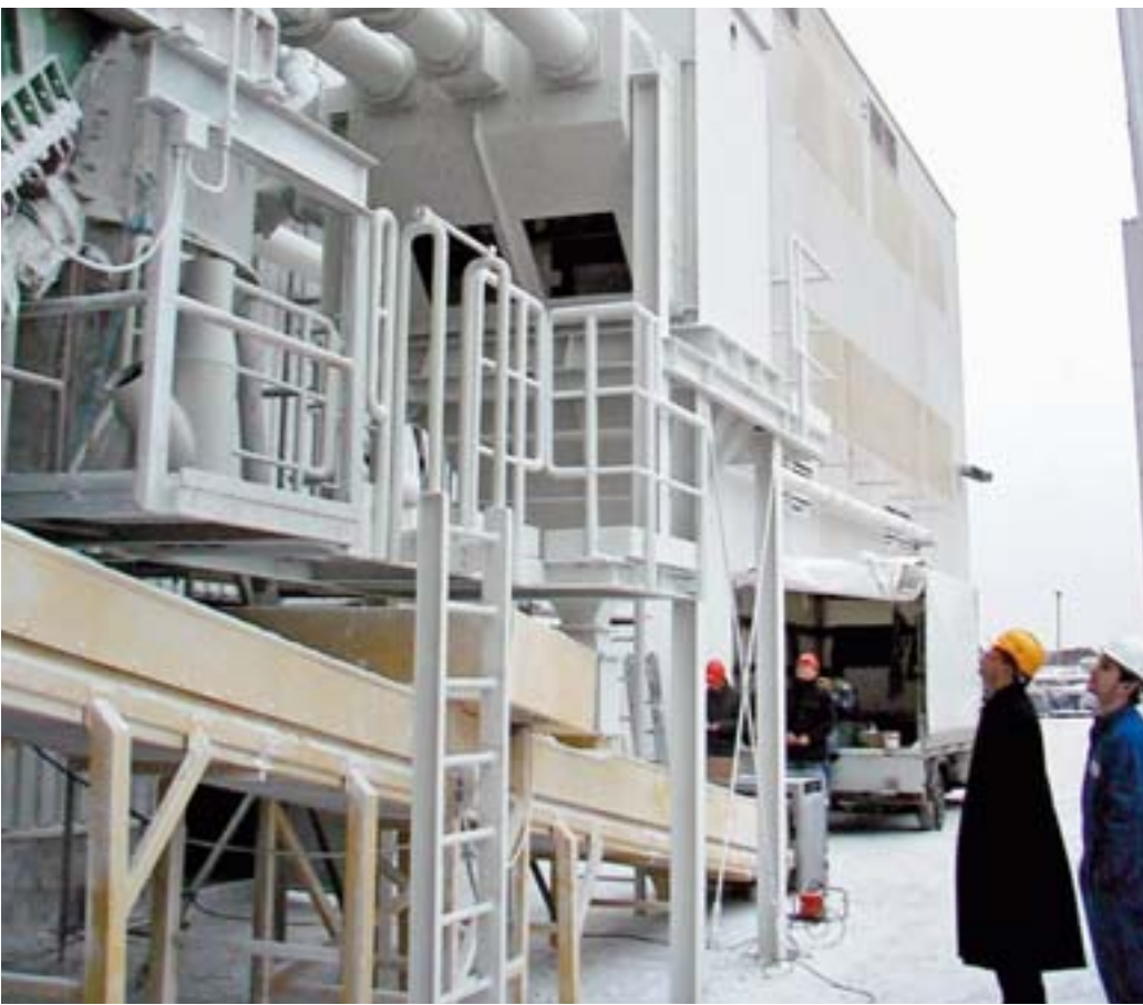
Für abrasive Medien: Komplettfiltersystem zur Abscheidung von Tabularoxid
